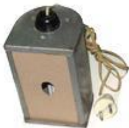
Фото. Самодельный овоскоп из фото-фонаря с лампой КЛЛ мощностью 25 вт.
