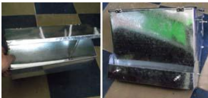
Фото. Цельнометаллическая бункерная кормушка с винтами для крепления
